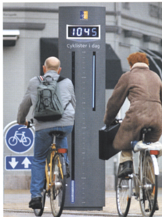
Cykelbarometer. Odense Cykelby har udviklet et cykelbarometer, der tager pulsen på cyklismen i byen. Over 7000 cyklister passerer hver dag cykelruten i Vestergade, hvor de bliver registreret af små sensorer, der er bygget ned i vejbelægningen
